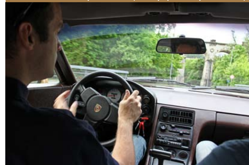
Poloha za volantem je maximálně pohodlná i pro postavu s výškou přes 190 centimetrů. Přístroje obsahují všechny důležité údaje, spínací skříňka je narozdíl od 911 vpravo. Zajímavostí je výškově seřizitelný volant, jehož poloha se nastavuje společně s celou kapličkou.
