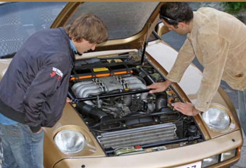
Osmiválec dokáže bezezbytku vyplnit motorový prostor. Vpředu je vidět mohutná spojovací trubka výklopných světel.
