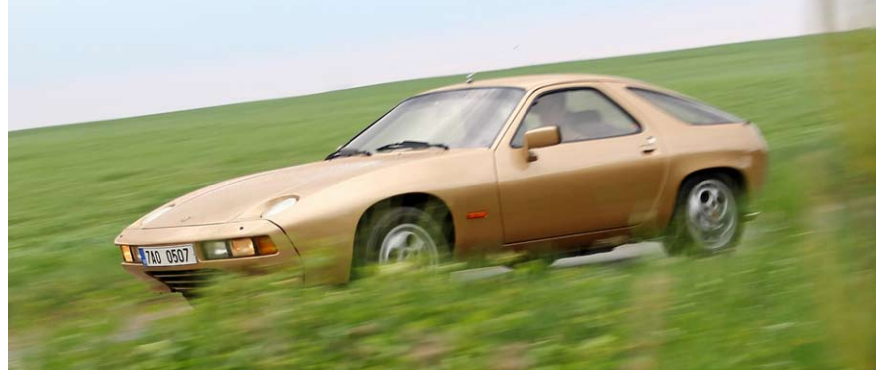
Siluetu dává vyniknout dlouhé přídí ukrývající mohutný osmiválec. Kapota, blatníky i boční dveře jsou z hliníku.
